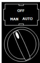
**MODO MAN. (MANUAL)** - permite que o usuário ligue **SOMENTE** a bomba de água (caso a bomba de água tenha sido ligada no contator auxiliar do equipamento).
